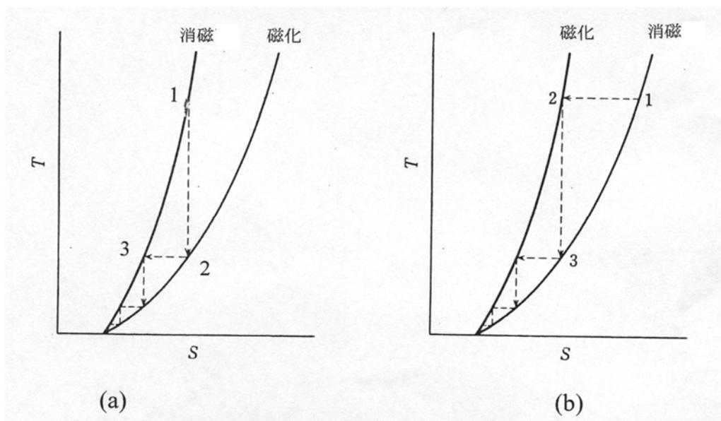
図-2  $T-S$  図上で表した断熱消磁法による冷却システムの表現.
