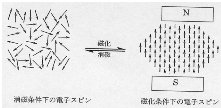
図-1 消磁および磁化条件下における磁気モーメント群.
