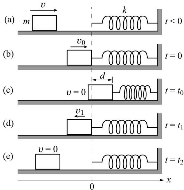
図1 一端を壁に固定したバネに衝突する物体の運動。
